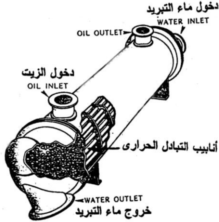
شكل رقم 11-9 نموذج المبادلات الحرارية (مبرد زيت)
